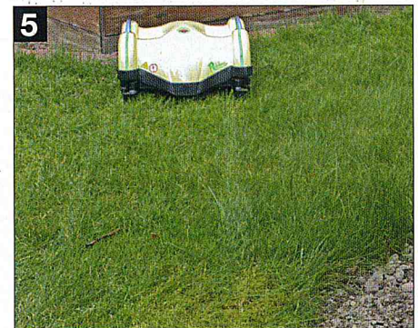
(4) Die flexiblen Schnittmesser des Husqvarna Automower arbeiten sehr leise (5) Gerät der Robby Garden XP zu nah an einen Beetrand, kann er sich festfahren
