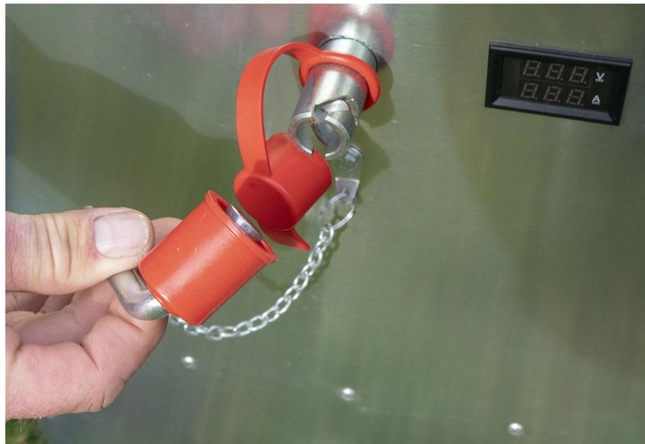
Abbildung 9: Aufstecken des Hebels auf den Hauptschalter
