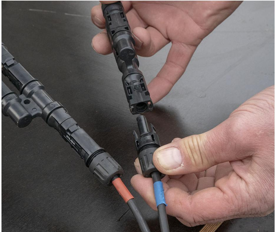
Abbildung 6: Steckverbindungen verbinden
